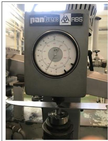
Figura 5 - Durômetro Rockwell com carga aplicada sobre amostra
